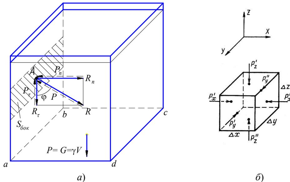
Рис. 2.1. Схема, иллюстрирующая свойства гидростатического давления
