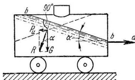
Рис. 2.6. Движение цистерны с ускорением
