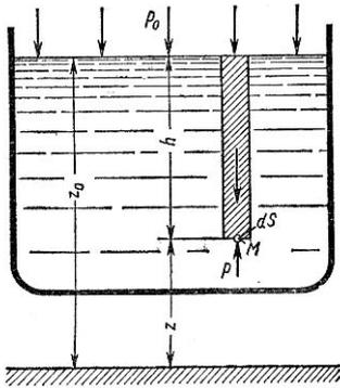
Рис. 2.2. Схема для вывода основного уравнения гидростатики
